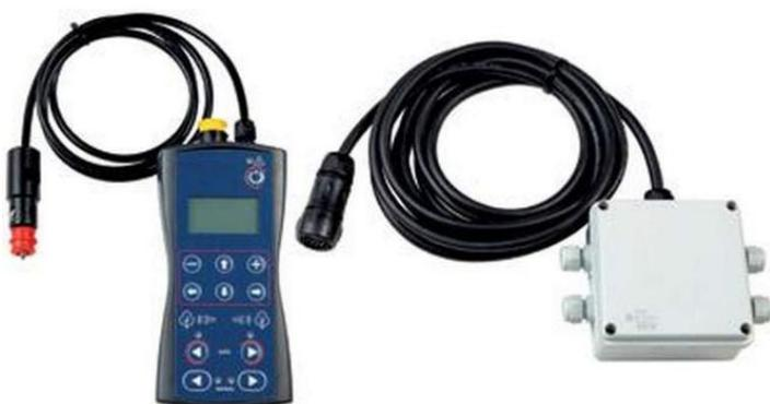
Figura 5.10 – Kit SONAR (consola + caixa de ligações)
