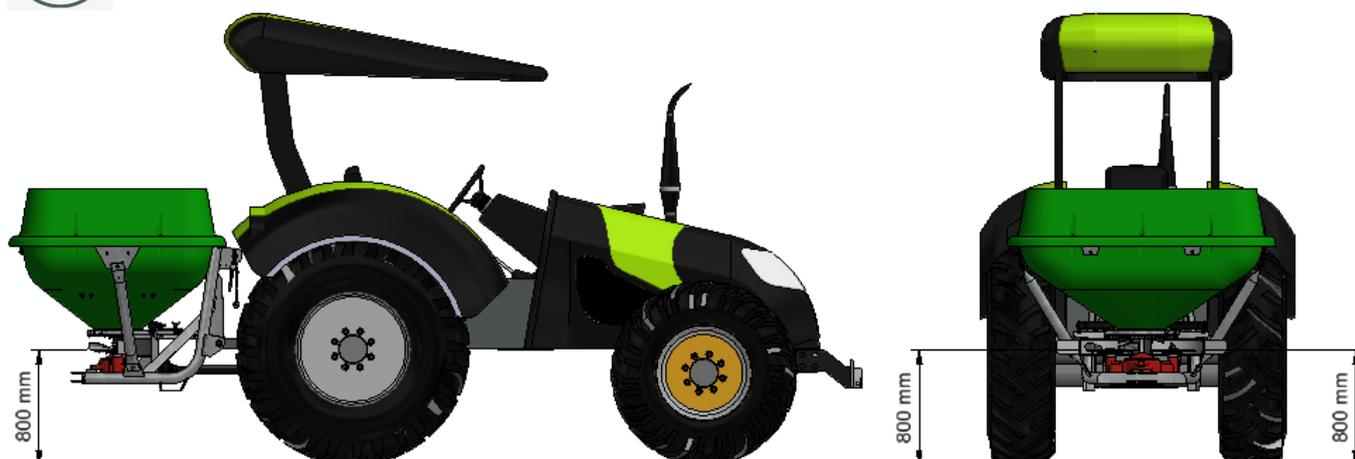
*Figura 5.2 – Ex. do ajuste da máquina na posição de trabalho.*
