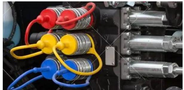
*Figura 5.6 – Ex. Válvula engate rápido do trator*
